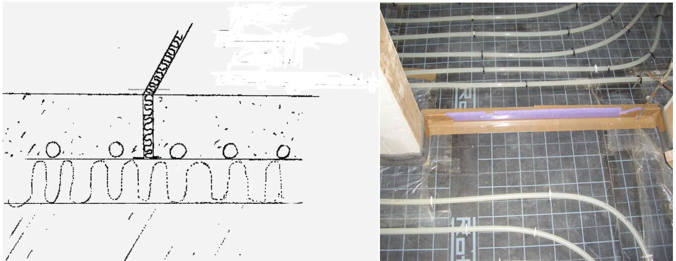
Bild 4: Handskizze Bewegungsfuge nur Estrich.
